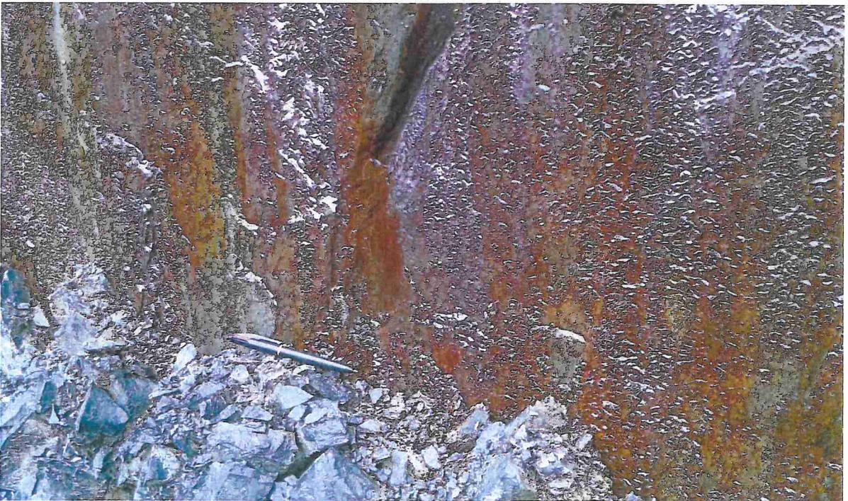
**Figure 4 – Suintements sur un plan de faille est-ouest parallèle au front de taille (VE67). La teinte rouge est due à la précipitation de fer ferrique.**
